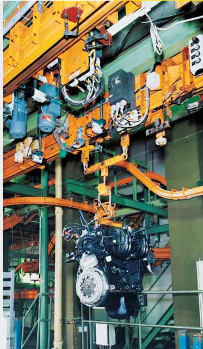
*Каждый день на моторостроительном заводе Саксон ВВ (Saxon VW) около 2200 двигателей проходят проверку, транспортируются и останавливаются при помощи оборудования Siemens. Решение использовать компактные стартеры системы Интерфейс AS для контроля двигателей привело к получению большого количества преимуществ в области планирования, монтажа и сдачи в эксплуатацию.*
