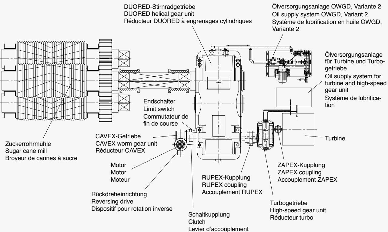
**Stirnradgetriebe mit DUORED-System für den Antrieb von Zweiwalzenpressen**
