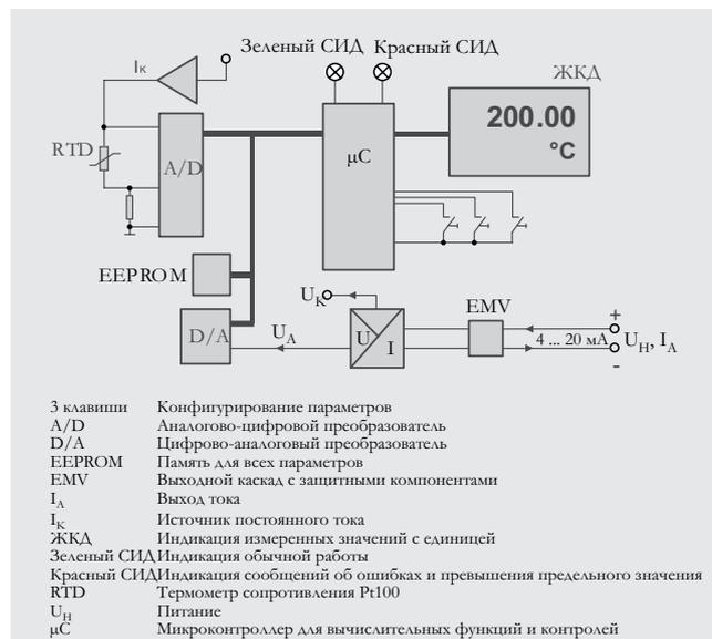
Питание внешнего датчика температуры Pt100 осуществляется от источника постоянного тока  $I_K$ . Тем самым через датчик создается соответствующее температуре падение напряжения.
